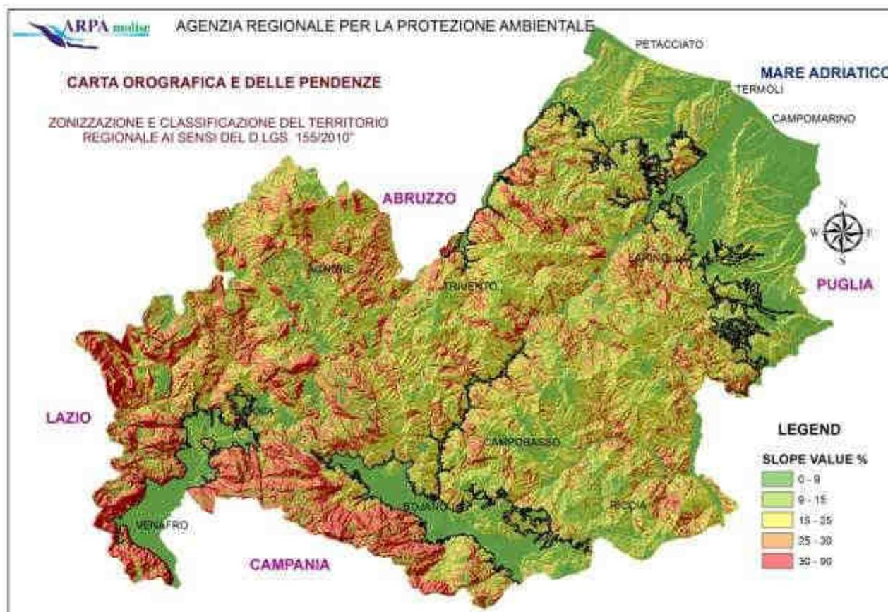
Figura 1 - Schema orografico redatto a partire dalla sovrapposizione di una Carta delle Pendenze con il DEM (25 metri) della Regione Molise; in evidenza il contur delle aree pianeggianti.
